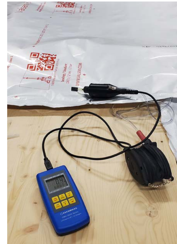
Mise en place de la poche avec l'œuvre et les sachets absorbeurs d'oxygène
